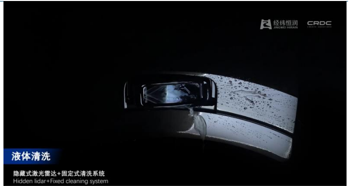
图表33: 经纬恒润已开发出双侧固定式清洗系统
