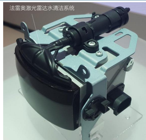
图表13: 法雷奥激光雷达清洗装置
