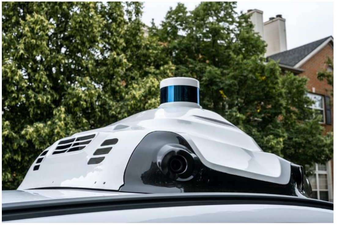
图表14: 福特第四代自动驾驶测试车拥有更强大的传感器清洁系统
